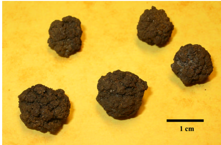
Fig 4. Sfäriska noder med ojämn knölig yta. (Provtagningsstation 1979-24)
