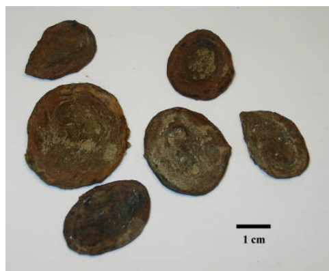
Fig 8. Flata, rundade noduler, s.k. penningmalm (Provtagningsstation 1982-60)
