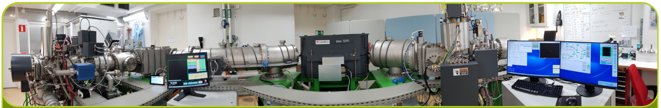
Panoramabild av jonmikrosonden (masspektrometern) i Nordsim-laboratoriet. Foto: Naturhistoriska riksmuseet
