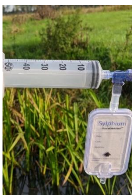
Bild 7. 50-ml spruta fäst vid filtret.
