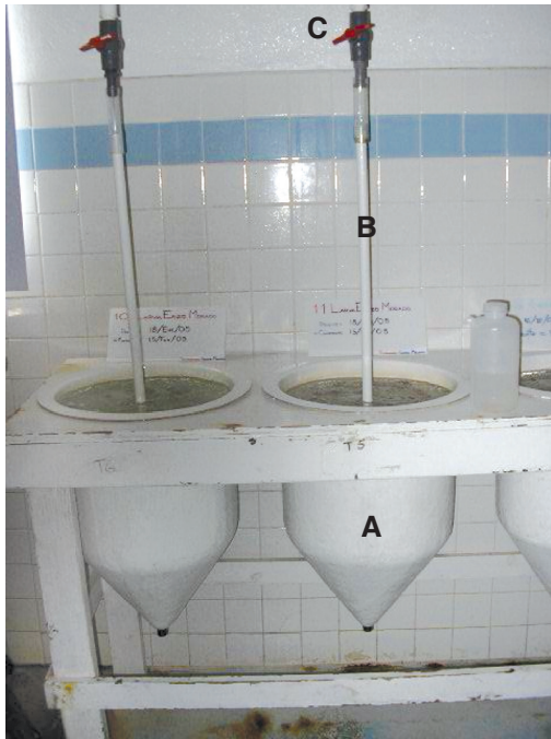
Fig. 1. Tanques cónicos de 45 l (A) utilizados para el cultivo de larvas de erizo rojo Strongylocentrotus franciscanus . Se puede apreciar el tubo de PVC de ¼ de pulgada (B) que provee de aireación al tanque, y en la parte superior la llave de paso que permite regular el flujo de aire (C).
