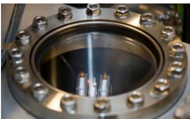
NORDSIMs detektorer i vakuum mäter provets isotopsammansättning. Foto Staffan Waerndt.
